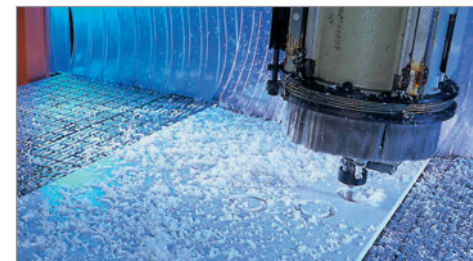
CNC-Fräsen einer Kunststoffplatte
