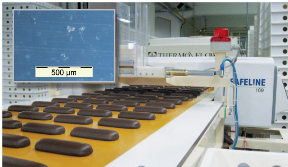
Wykrywacz metalu w zastosowaniu do produkcji słodczy; po lewej u góry: zdjęcie mikroskopowe wykrywalnych wiórków metalowych w dehoplast® x-detect
