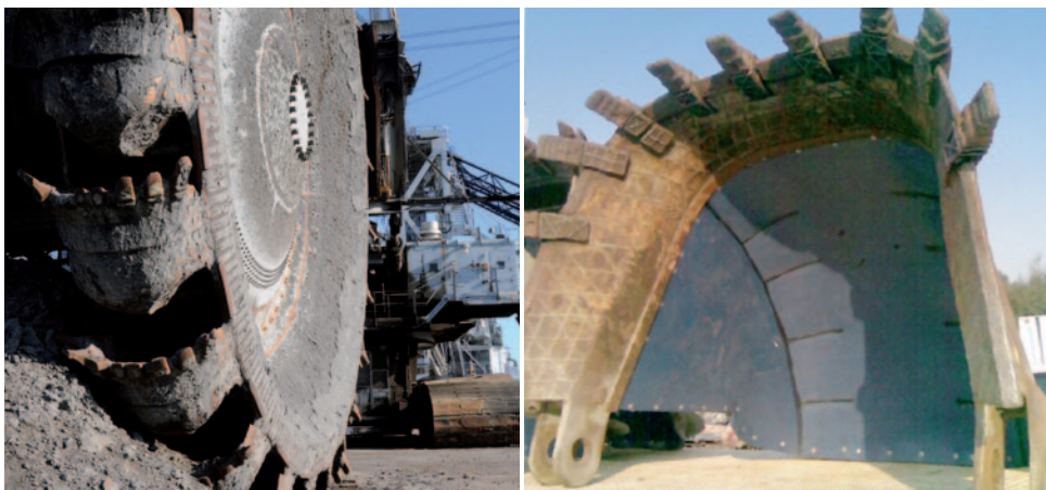
Okładziny z materiału dehoplast® superlining stosowane w urządzeniach do wydobywania węgla w kopalniach odkrywkowych w Australii
