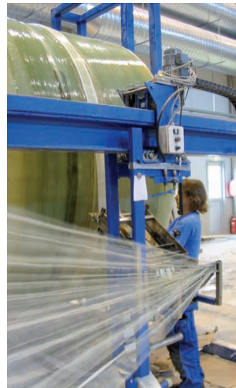
Aufbringen der GFK-Struktur durch Filamentwicklung auf den darunterliegenden Liner-Werkstoff SIMONA® E-CTFE-AK
