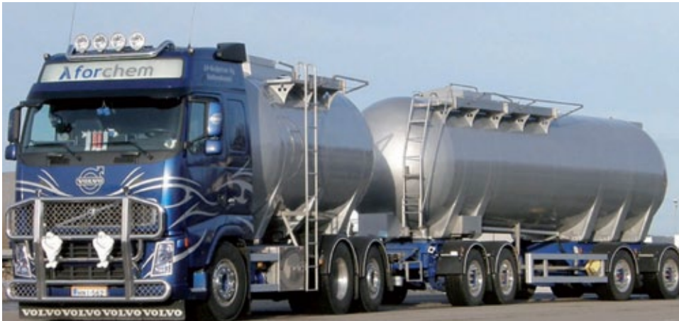
Straßentransporttanker 18 bzw. 31 m³ aus 2,3 mm SIMONA® E-CTFE-AK in Duallaminatbauweise
