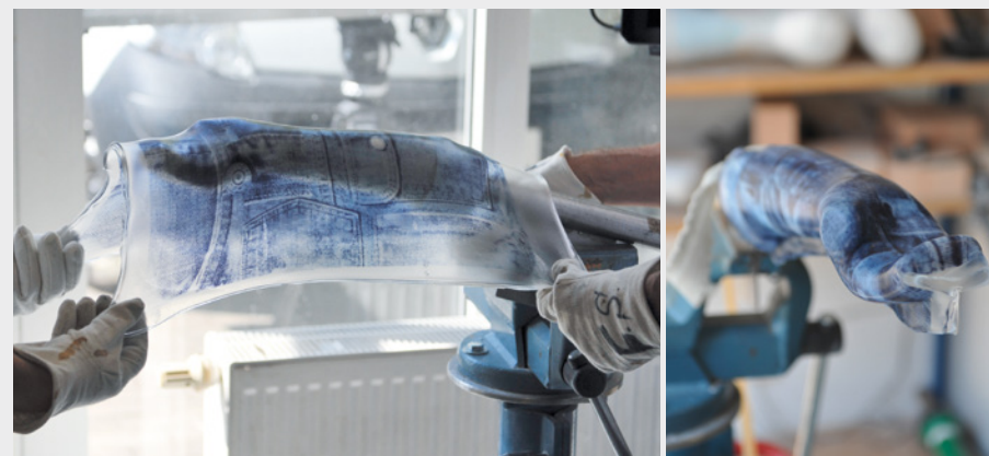
Tiefziehen einer mit Thermopapier eingefärbten SIMONA® SIMOLIFE PE-HWV Platte über das Gipsmodell eines Unterarms.
