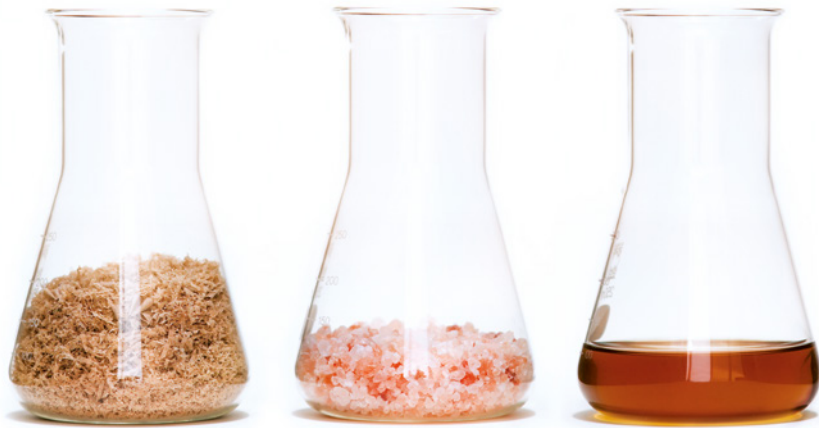
Reishülsen, Steinsalz und Mineralöl bilden die Basis für das Resysta® Compound.
