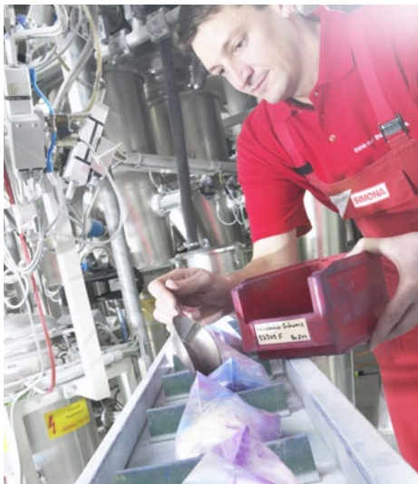
Własna mieszalnia PVC pozwala prowadzić prace nad tworzywami o nowych właściwościach
