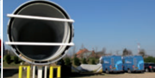
Abb. v.l.n.r.: Blick in die untere Röhre mit Gaseintritt, Transport der SIMONA® E-CTFE-GK/GFK Verbundröhren, SIMONA® E-CTFE-GK/GFK/Stahl fertig für den Transport
