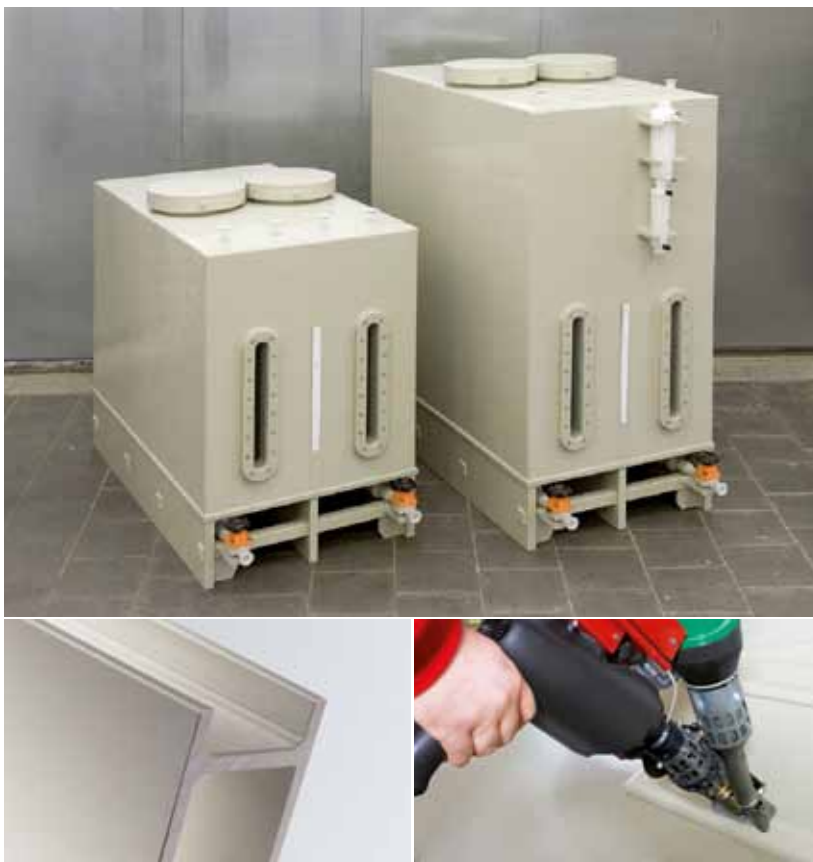
Behälter aus SIMONA® PP-DWU AlphaPlus® Hohlkammerplatten ersetzen bei der Herstellung von Aprotinin korrosionsanfällige Stahltanks zur Lagerung von sauren Chromatographie-Pufferlösungen.
