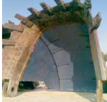
dehoplast® superlining'den kepçe kaplaması
