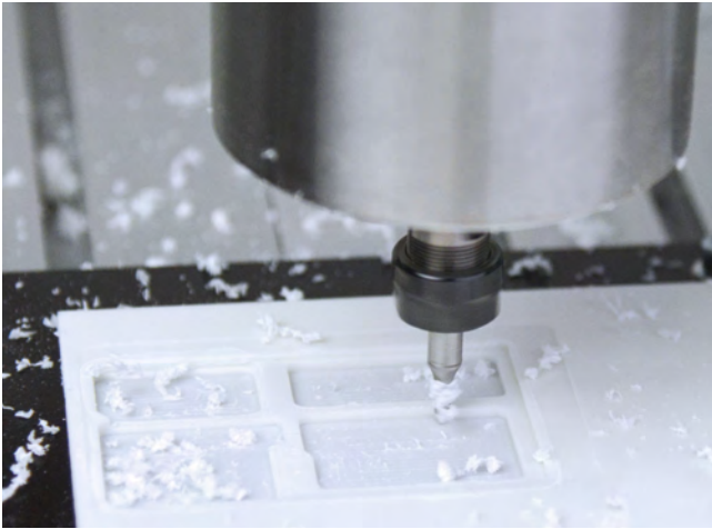
SIMOGREEN PLA-HT Platten überzeugen durch eine hochwertige Optik und hervorragende Fräsbarkeit (Beispiel: frei programmierbares elektronisches Etikett aus SIMOGREEN PLA-HT).
