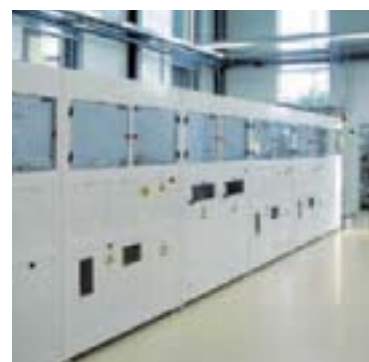
Banco de trabajo para ensayos por vía húmeda de SIMONA® PVC-C CORZAN FM 4910 G2
