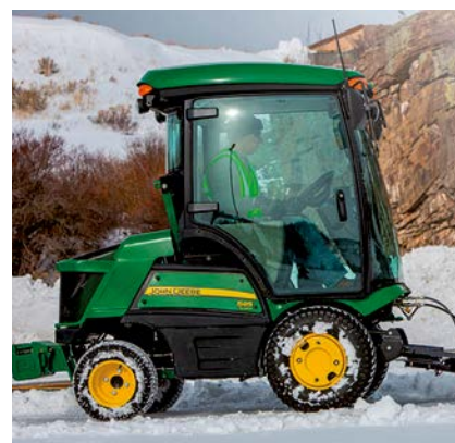
Kryt motoru traktoru John Deere z materiálu PMC® StrataGem™
