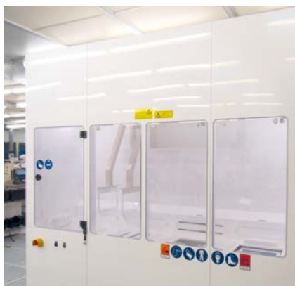
Těleso zařízení pro mokré procesy z bílých desek SIMONA® PP-H
