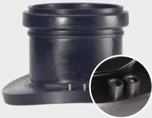
Anschlusskontakte der Heizwendel zur stoffschlüssigen Anbindung an den Hauptsammler durch Heizwendelschweißung.
