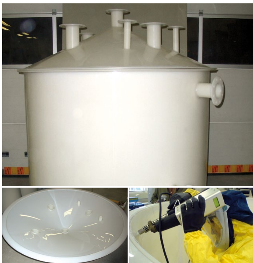
En haut : Cuve achevée. En bas : Couverture de la cuve, en plaques de PVDF d'épaisseur 8 mm. Soudage des semi-produits en PVDF.
