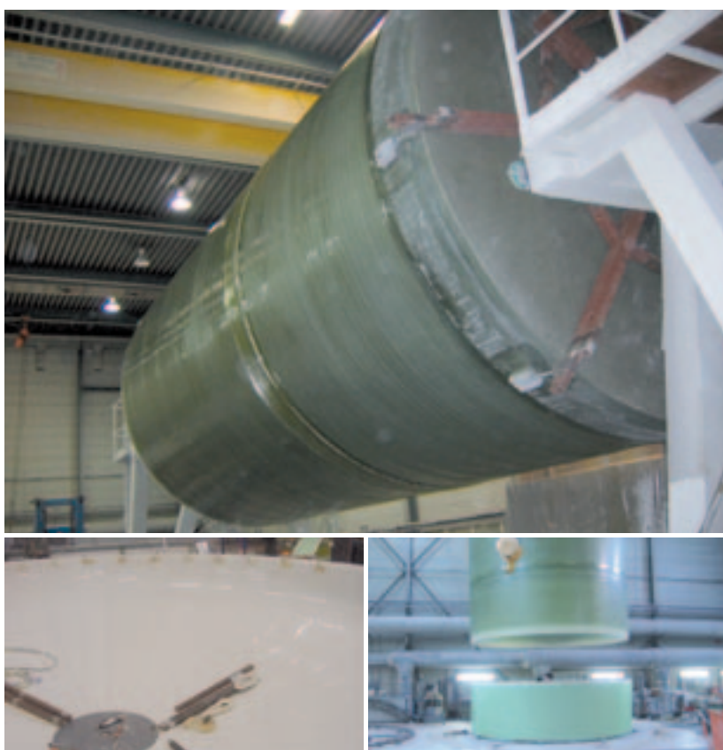
Die GFK-Verbundbehälter haben eine Höhe von elf Metern und einen Durchmesser von fünf Metern.
