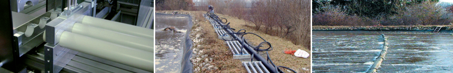
Abb. v.l.n.r.: Produktion der OXIWORKS® Belüfter; Montage der Belüfterketten; Praktische Anwendung
