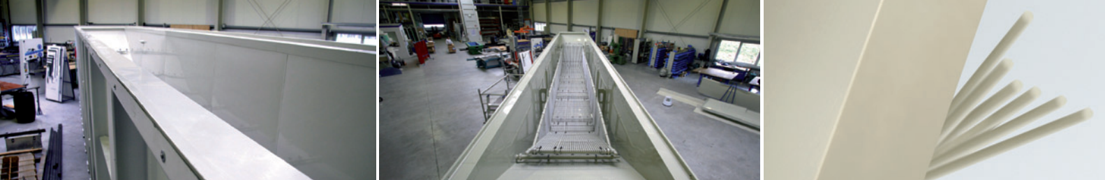
Abb. v.l.n.r.: Stahlwanne mit SIMONA® PP-DWU AlphaPlus Inliner, ausgekleidete Stahlwanne mit Auffangkorb, SIMONA® PP-DWU AlphaPlus Platte mit Schweißdrähten.
