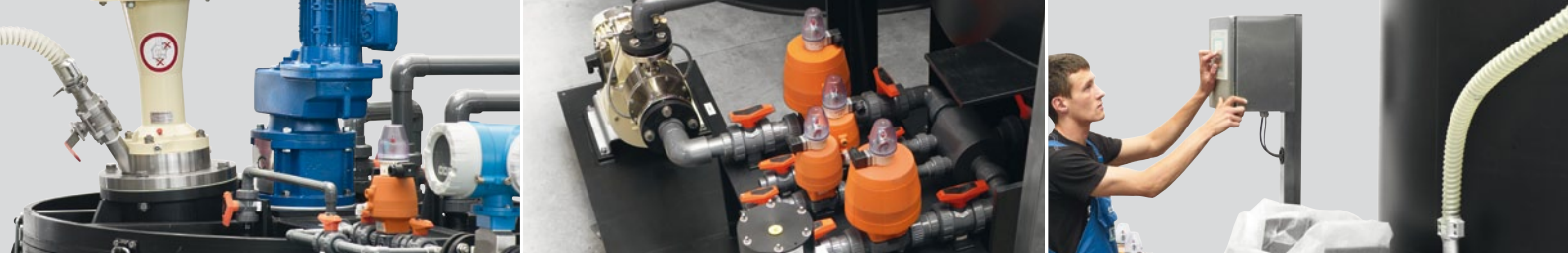
v. l. n. r.: Anschlüsse für Flüssigkeitszugaben, Armaturen und Hochleistungsdispensierer; Separater Wärmetauscher zur Temperatursenkung; Überwachung der Prozessstände
