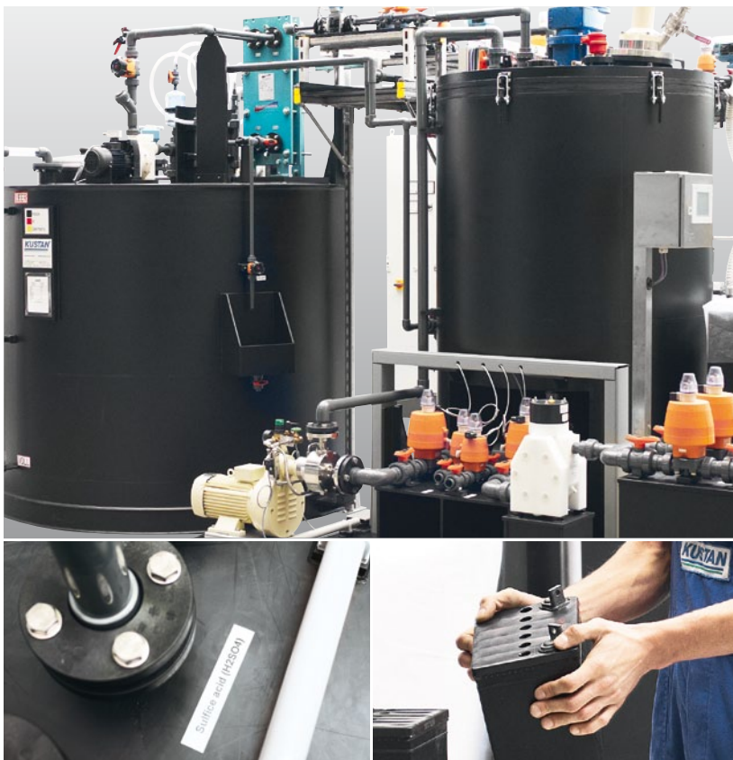
Die Behälter der Mischanlage im Überblick. Alle Bestandteile müssen den aggressiven Säuren dauerhaft standhalten.
