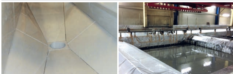
Oben: technische Zeichnung einer KTL-Tauchanlage; unten links: KTL-Wanne mit SIMONA® PP AlphaPlus® Inliner; unten rechts: mit Flüssiglack befüllte KTL-Wanne
