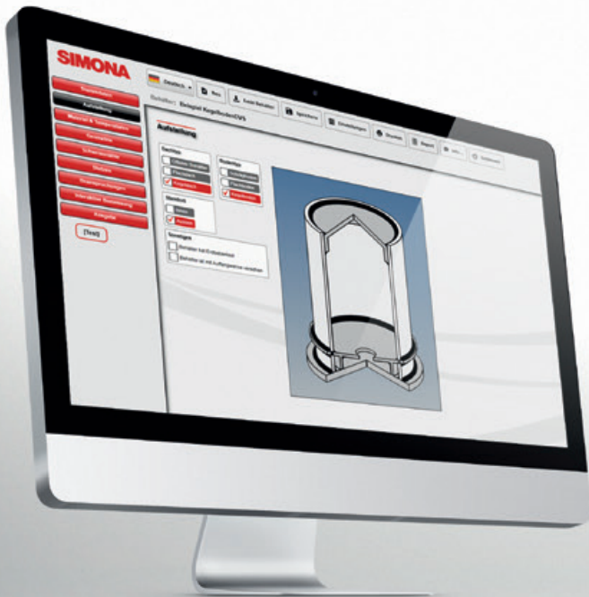
Rundbehälterberechnung – alle Geometrien an Dächern und Böden nach DVS sind berechenbar.
