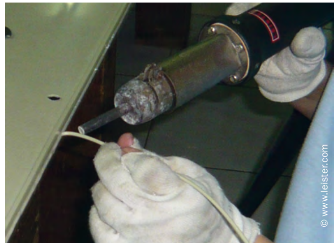
Abbildung 4: Warmgasfächelschweißen mit Rundscheidraht
